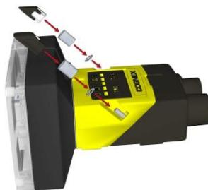
2. Отсоедините основной модуль и модуль ввода-вывода, плотно потянув их друг от друга.
